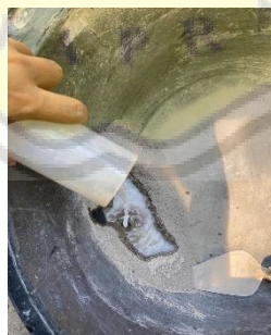
Gambar E.13 Penuangan Air Sebanyak 118 ml
