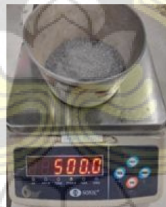
Gambar C.2 Agregat Halus Seberat 500 Gram
