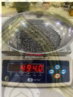
Gambar D.5 Agregat Halus Yang Tertahan Ditimbang
