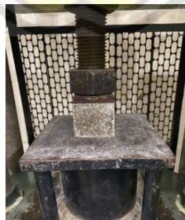
Gambar 4.15 Peletakkan Benda Uji Mortar Pada Mesin Kuat Tekan
