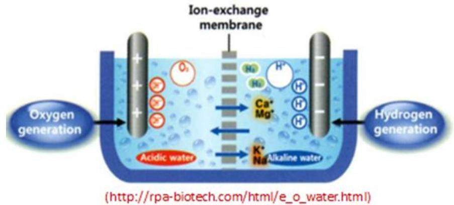
Gambar 4.1. Prinsip reaksi kimia untuk produksi *electrolized water*
