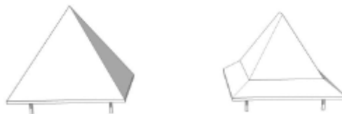
Gambar 98. Atap Tajuk Yang Berkembang Menjadi Joglo (Tajuk Koro) Dengan Cara Ditumpuk
