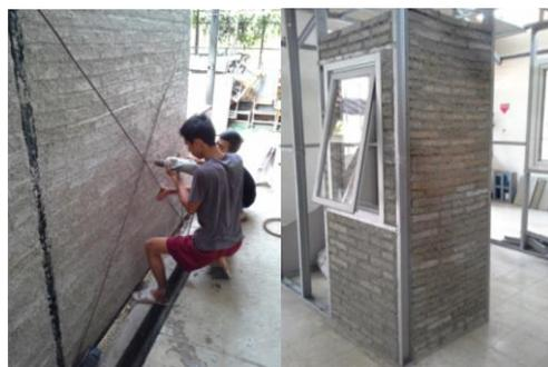
Gambar 2. Uji beban lateral dimensi luas dinding *Pulpy Granule – Tapioca*
