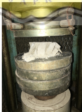
Gambar 4.14 Peletakan Benda Uji Mortar di Mesin Kuat Tekan
