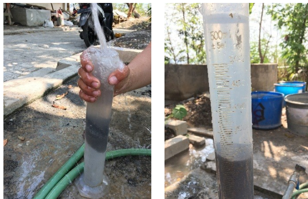
Gambar 4.8 Proses Menghilangkan Kadar Lumpur
