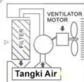
Gambar 80 Prinsip cara kerja Misting Fan
