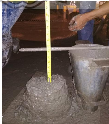
Gambar 3.120. Proses Pengujian Nilai Slump Sumber: Dokumentasi Pribadi, 2019
