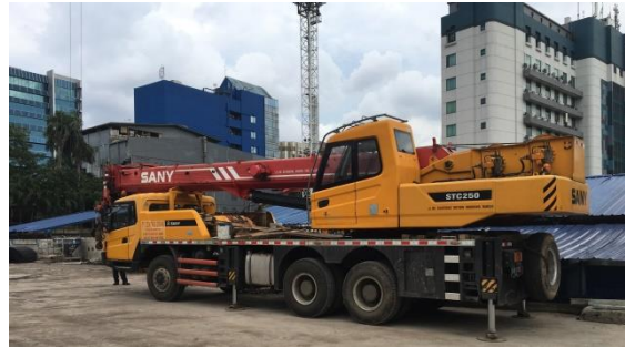
Gambar 3.96. Mobile Crane Sumber: Dokumentasi Pribadi, 2019
