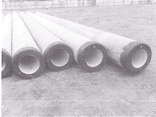
Gambar 5.2 Tiang Pancang (Sumber: Dokumentasi Pribadi tahun 2010)
