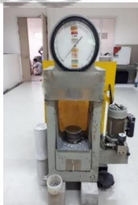
Gambar 3.5 Alat Pengujian Kuat Tekan Beton
