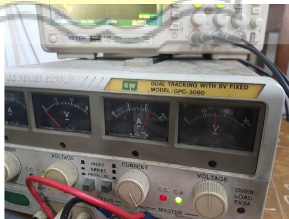
Gambar-4.11 Tegangan dan arus yang keluar dari power supply DC pada mode operasi magnetizing-freewheeling
