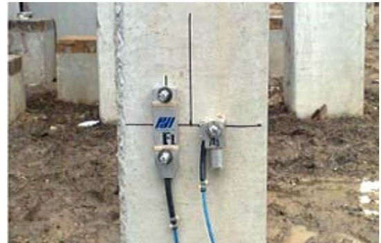
Gambar 3.19 Pemasangan *Starin Transducer* dan
