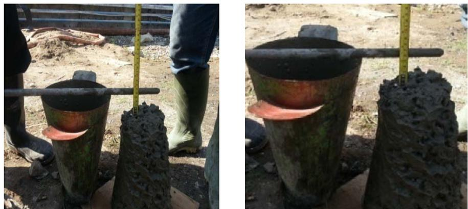
Gambar 3.78 *Slump Test* pada Pekerjaan *Pile Cap*
