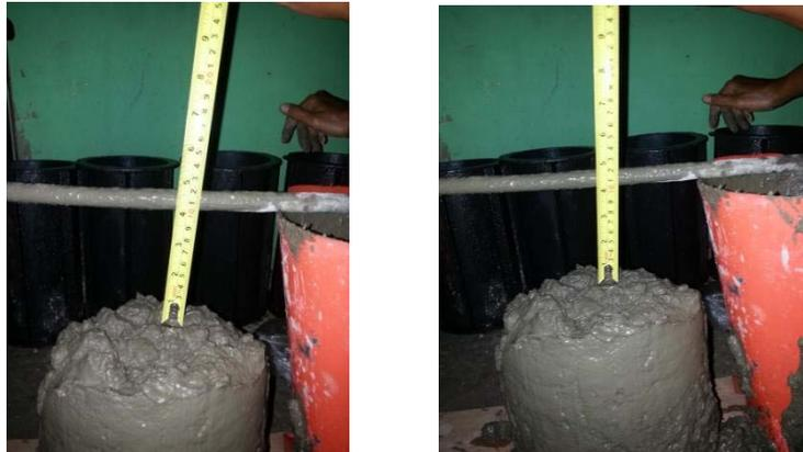
Gambar 3.77 *Slump Test* pada Pekerjaan Lantai *basement*.
