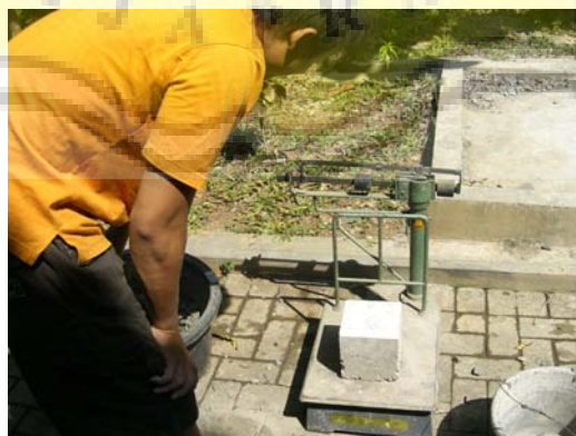
Penimbangan benda uji sebelum diuji kuat tekan (Sumber: dokumentasi pribadi)
