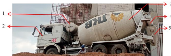
Gambar 4.4 Bagian-Bagian dari Truck Mixer
