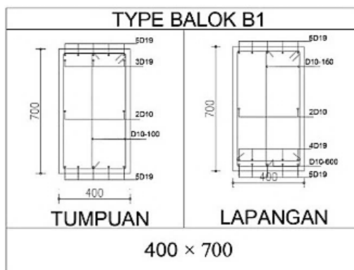
Gambar 3.16 Detail Balok B1 (Sumber: Diolah dari Gambar DED Proyek PT. SCCR Indonesia Pembangunan Universitas Agung Putra)
