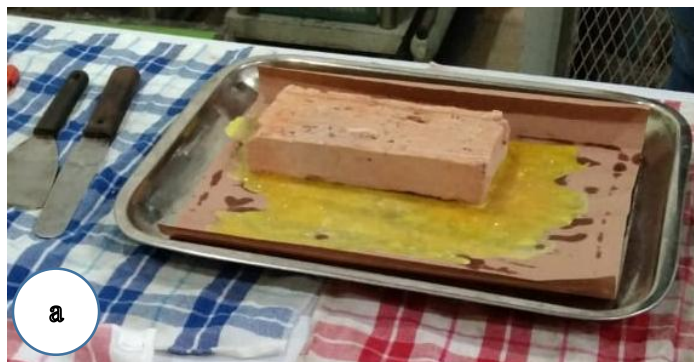
Gambar 1. Proses uji tekan specimen bata (a) Spesimen bata dilapisi sulfur untuk memastikan area tekan merata (b) Dilakukan uji tekan pada spesimen bata.
