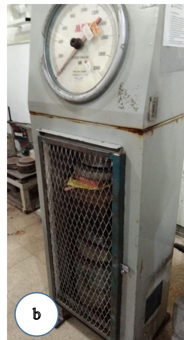
Gambar 1. Proses uji tekan specimen bata (a) Spesimen bata dilapisi sulfur untuk memastikan area tekan merata (b) Dilakukan uji tekan pada spesimen bata.
