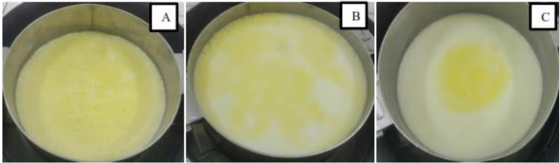
Gambar 2. Susu Pasteurisasi Hasil Pasteurisasi Tanpa Agitasi (A), Pasteurisasi dengan Agitasi 35 rpm (B), dan Pasteurisasi dengan Agitasi 70 rpm (C)
