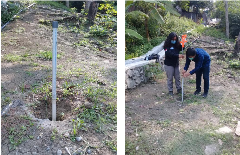
Gambar 5.4: Pipa Pralon Pengukur Pergerakan Tanah
