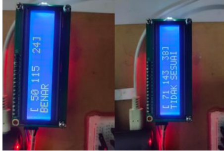
Gambar 6 Tampilan LCD untuk Mengetahui Deteksi RGB secara Real Time pada Baris Pertama dan Pada Baris Kedua Menampilkan Hasil Pemilahan Jenis Daun muda atau Tua
