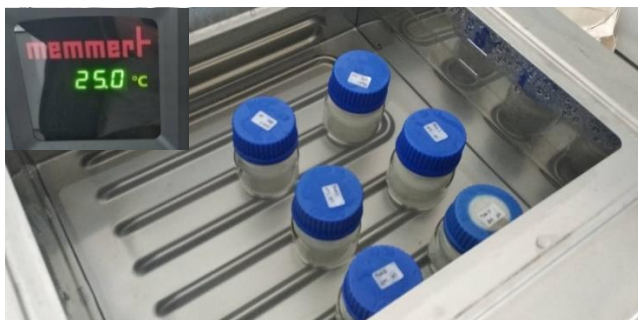
Gambar 8. Mengkondisikan Suhu Sampel Susu Menggunakan Waterbath
