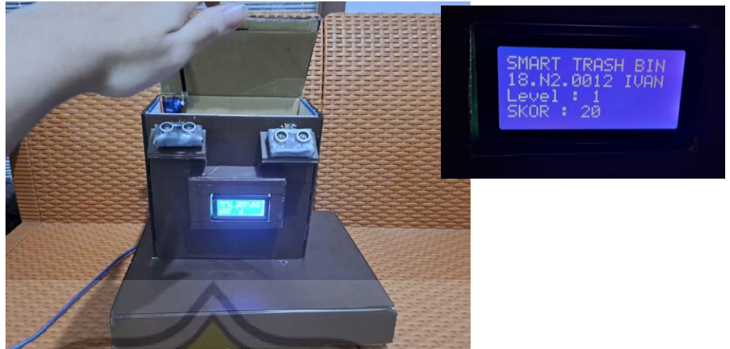
Gambar 4.10 Prototipe saat Arduino Tutup Tempat Sampah Terbuka dan Gambar 4.11 Tampilan Pada LCD Arduino
