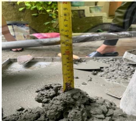
Gambar 4.5 Hasil Uji Slump Beton Geopolimer 10,5 Mol
