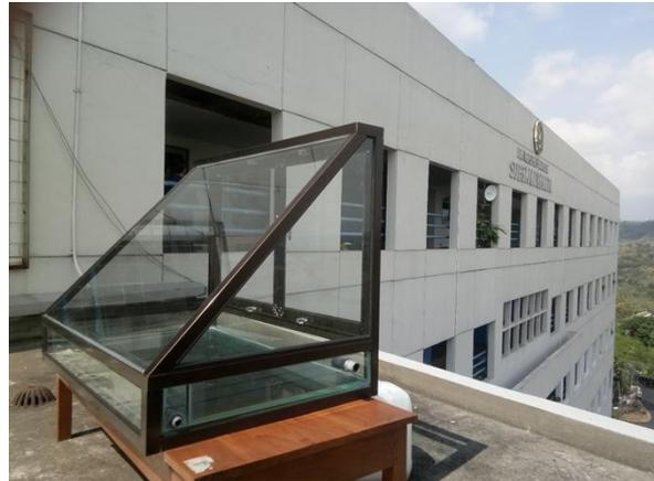
Gambar: Pelaksanaan Uji Coba Prototipe Alat Desalinasi di Atap Gedung Henryconstan, Unika
