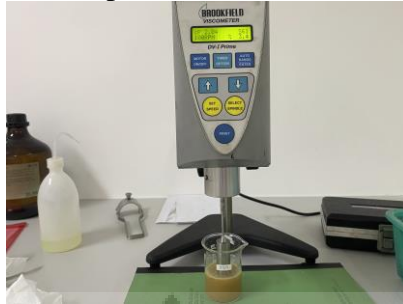
Lampiran 87. Uji Viskositas Sampel Larutan Bubuk Gelatin
