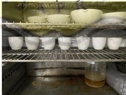
Lampiran 78. Pengovenan Cawan Sampel Uji Kadar Lemak
