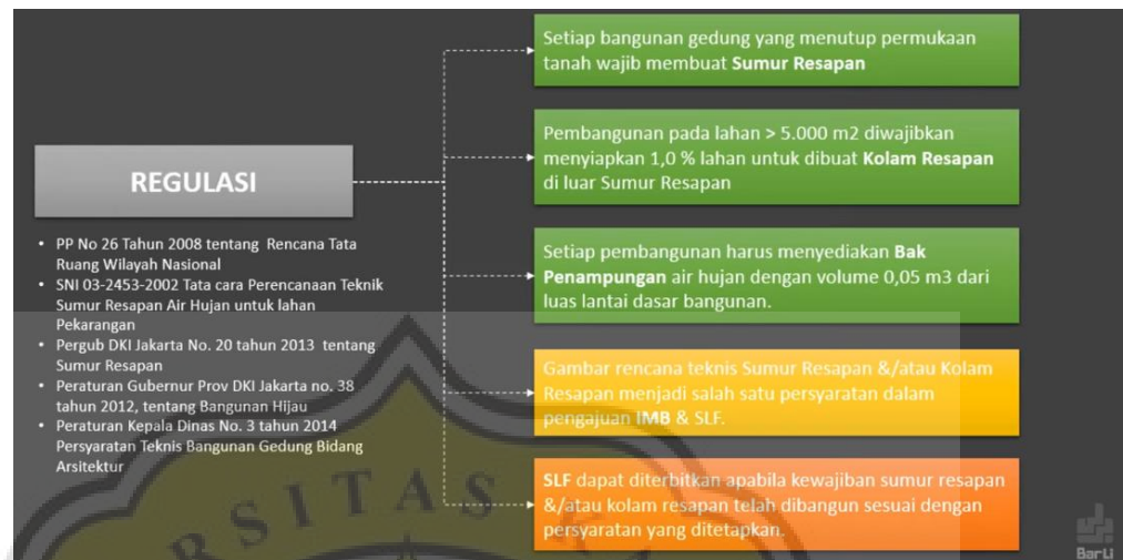
Gambar 122 Regulasi Sumur Resapan
