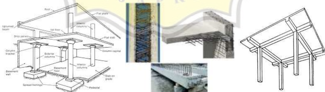
Gambar 6.5 Kolom, Dinding, Plat Lantai Sumber : (Krishna 2020)
