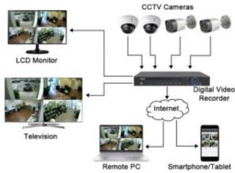
Gambar 6. 22. Skema Alur Kerja CCTV
