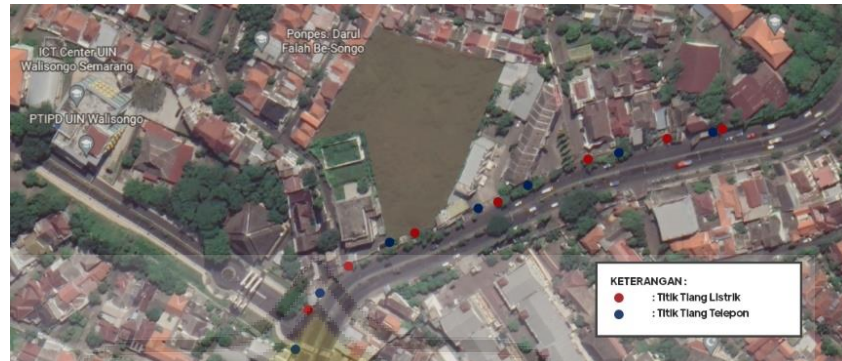
Gambar 43. Analisis Titik Tiang Listrik dan Lampu
