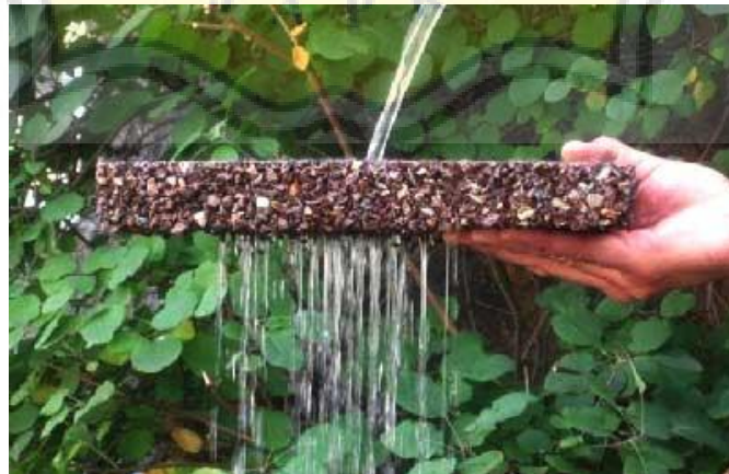
Gambar 6 2 Ilustrasi saat Bahan Porous Pave Terkena Air Sumber : geosolutionsinc.com
