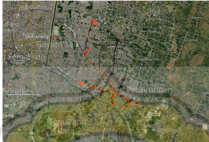
Gambar 2 12 Jaringan Drainase Sumber: E-Drainase Kota Semarang, 2022
