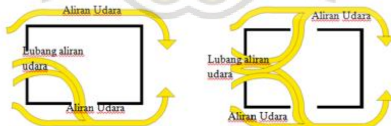
Gambar 2. 9 Angin Bertekanan Rendah Pada Sisi Samping Kiri dan Kanan. Sumber : Ramadhania Irma, 2013
