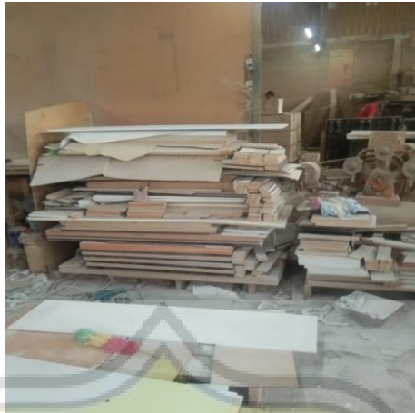
Gambar 1.8 Penataan Barang yang Tidak Rapi
