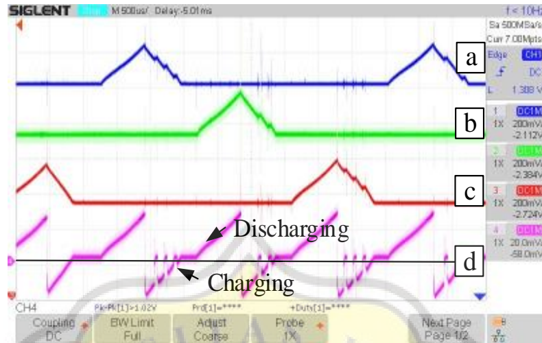
Gambar- 4.10 (a) Arus fasa A (b) arus fasa B (c) arus fasa C (d) arus pengisian baterai pada duty cycle 25%
