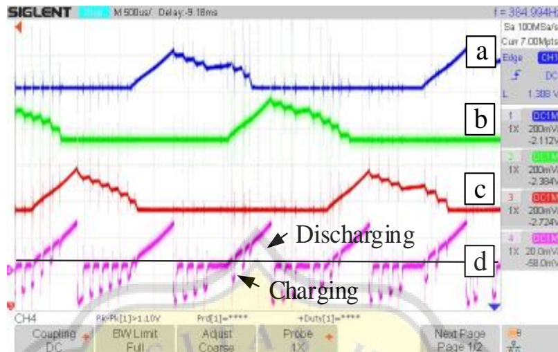
Gambar- 4.6 Hasil percobaan (a) arus fasa A (b) arus fasa B (c) arus fasa C (d) arus pengisian baterai pada duty cycle 75%
