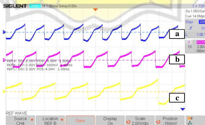
Gambar-4.12 Hasil percobaan arus baterai dengan single pulse pada kecepatan awal 1800 RPM (a), 1500 RPM (b), 1200 RPM (c)
