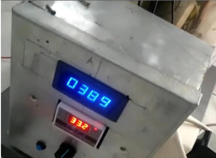
*Gambar 2.1.6.2 Panel Kontrol Elektronik untuk Pengaduk dan Temperatur*
