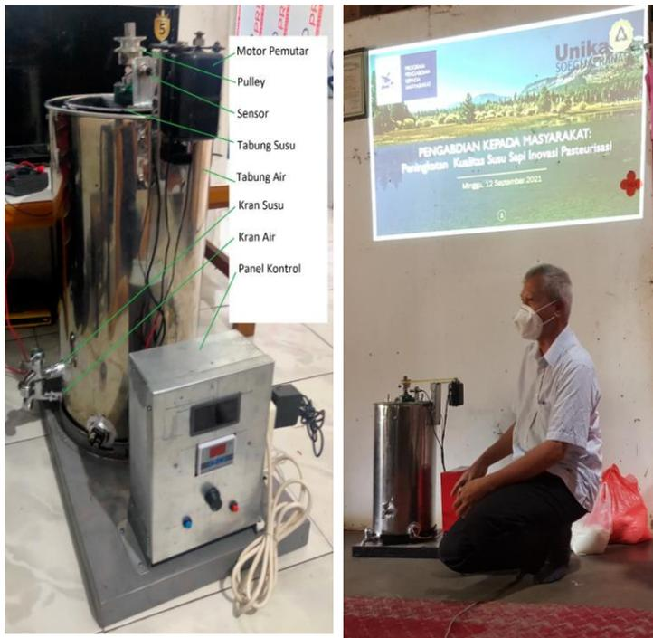
*Gambar 1.2.4 Alat pasteurisasi yang dimodifikasi untuk skala rumah tangga*
