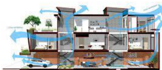
Gambar 98 Skema ventilasi silang pada bangunan
