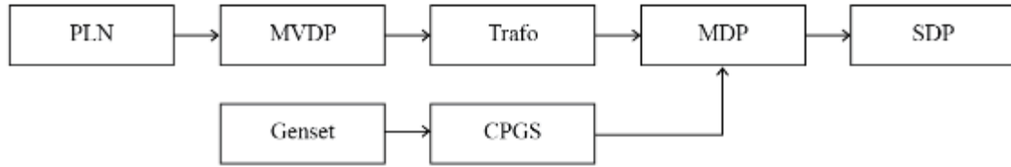
Gambar 3.3. 1. Distribusi Listrik (Sumber : Analisis Pribadi)
