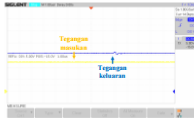
Gambar 19: Tegangan keluaran pada implementasi perangkat keras cak converter dengan metode PI referensi 3 A.
