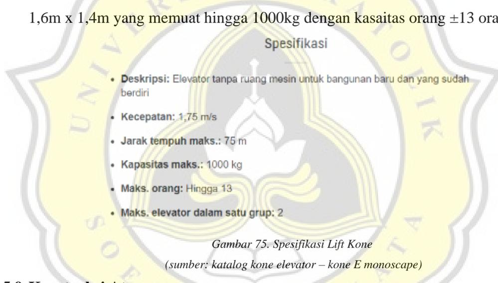
Gambar 75. Spesifikasi Lift Kone
