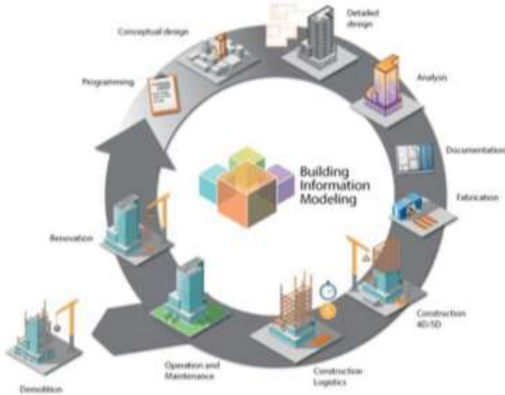
Gambar 93. Siklus Konstruksi Dengan Menggunakan BIM [35]
