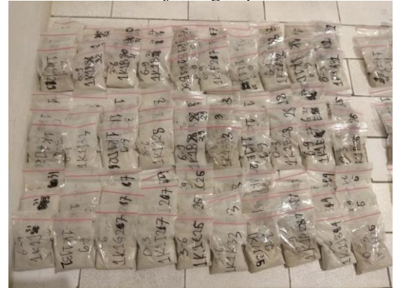
Gambar 21. Sampel serbuk beton untuk uji ion klorida. (Sumber: Penulis, 2017)
