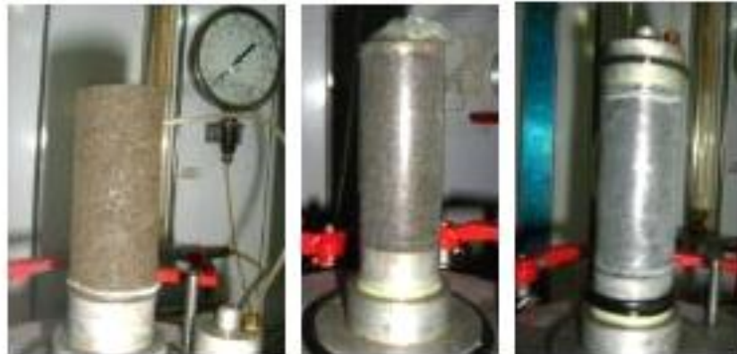
(d) (e) (f) Gambar 6 (d,e,f). Pemasangan Sampel Pasir 0% Semen pada Alat TX
