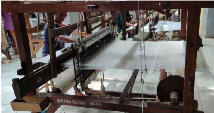
Gambar 16 Mesin Tenun Manual Untuk Produksi memanfaatkan serat daun nanas, serat pelepah pisang, serat tanaman dan serat tanaman lidah mertua
