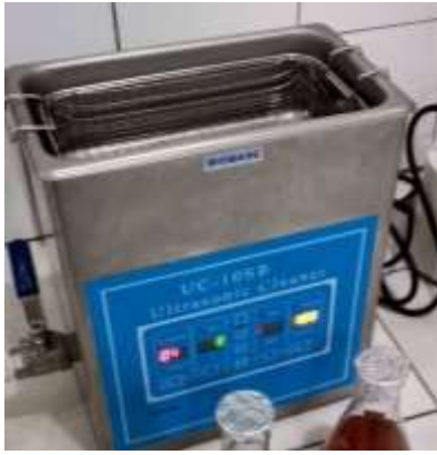
Lampiran 9. Ekstraksi Larutan Serbuk dalam Metanol menggunakan Ultrasonic Cleaner UC-10SD
