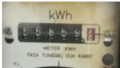
Gambar 5.2: Pembacaan Digit Angka Terakhir Tidak Sempurna
