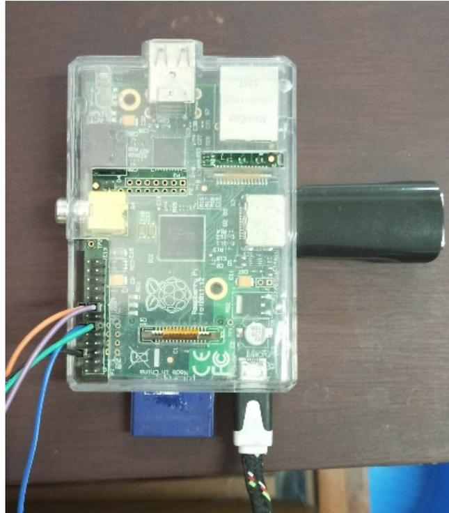
Gambar 3.3: Komputer Mini Untuk Operasional Kamera
