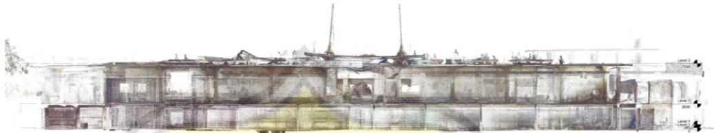
Gambar 4.3. Contoh hasil pemindaian wajah Johar dari Utara dengan 3D laser scanner.
