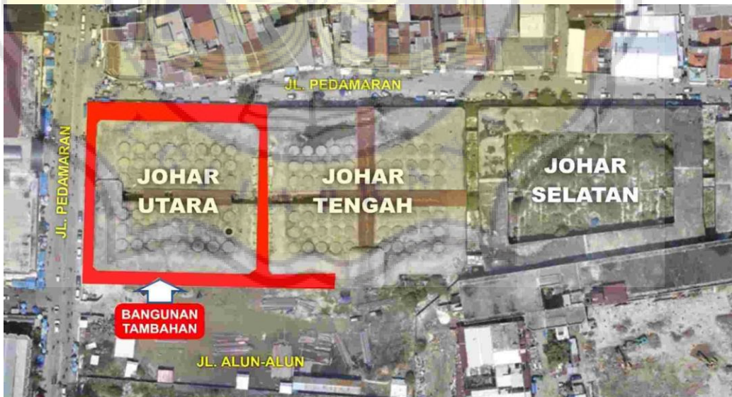
Gambar 4.9. Bangunan tambahan Johar yang dibongkar
