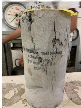
Gambar 4.3 Pola Keretakan Benda Uji Nomor 8A
