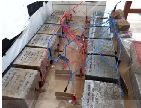
Gambar 4.5 Proses Uji Laju Korosi
