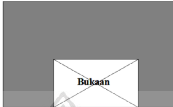
Gambar 4.10. Ketidakberaturan Diskontinuitas Diafragma (Sumber: SNI 1726:2019).
