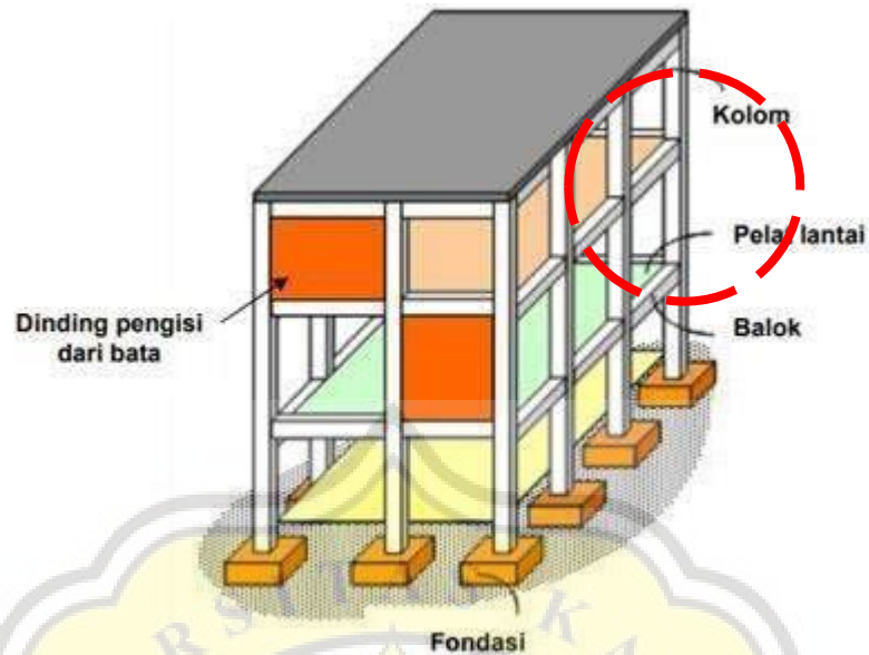
Gambar 66: Middle structure (Rangka Beton Bertulang)
