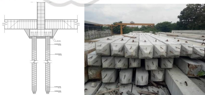
Gambar 3. 46 Pondasi Mini Pile (sumber: google image)
