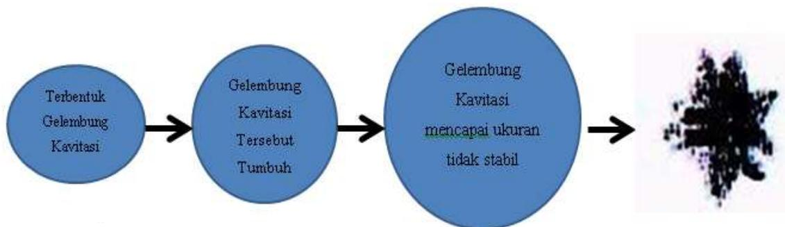
**Gambar 7 Mekanisme Pembentukan Gelembung Kavitasi**
